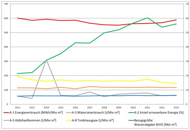
Der Kernindikator Energieverbrauch (A-1) hängt im Wesentlichen vom Stromverbrauch im Wasserwerk Homburg und im Pumpwerk Sinnerthal ab. Seit 2016 machen sich die Umstellarbeiten in der Brunnensteuerung im Wasserwerk Homburg bemerkbar, was zu einer Verringerung des Kernindikators Energieverbrauch führte. Der Anstieg seit 2020 rührt von einer gesteigerten Wasserabgabe sowie der erhöhten Förderung im Wasserwerk Homburg mit einhergehendem Mehrverbrauch an Pumpenenergie.
