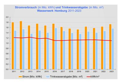
Im Wasserwerk Homburg konnte aufgrund der Optimierung der Brunnensteuerung mittels Frequenzumformer sowie dem Wegfall der Drosselung im Filterzulauf, seit 2015 eine Reduktion des spezifischen Energieverbrauchs um 7,7% erreicht werden.
