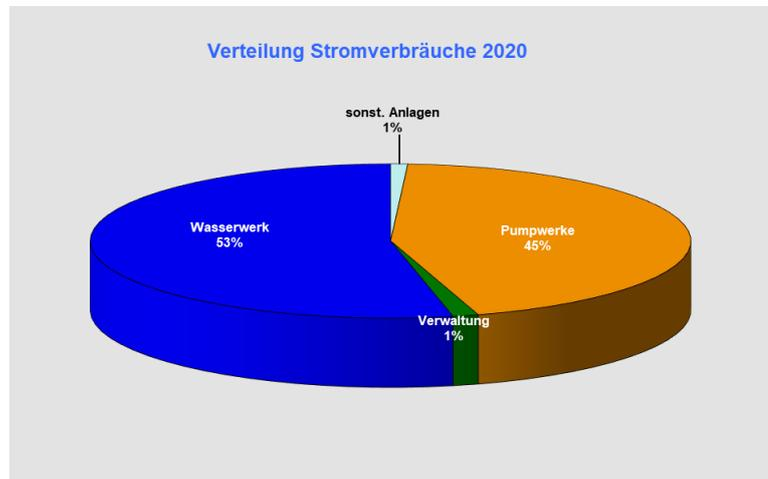
Die weiteren Außenanlagen (Hochbehälter und Verteilerschächte) benötigen mit rund 28.100 kWh sowie die Verwaltung am Standort Ottweiler und der Technische Service Eppelborn mit rund 42.200 kWh nur zusammen 2% des gesamten Energiebedarfs.
