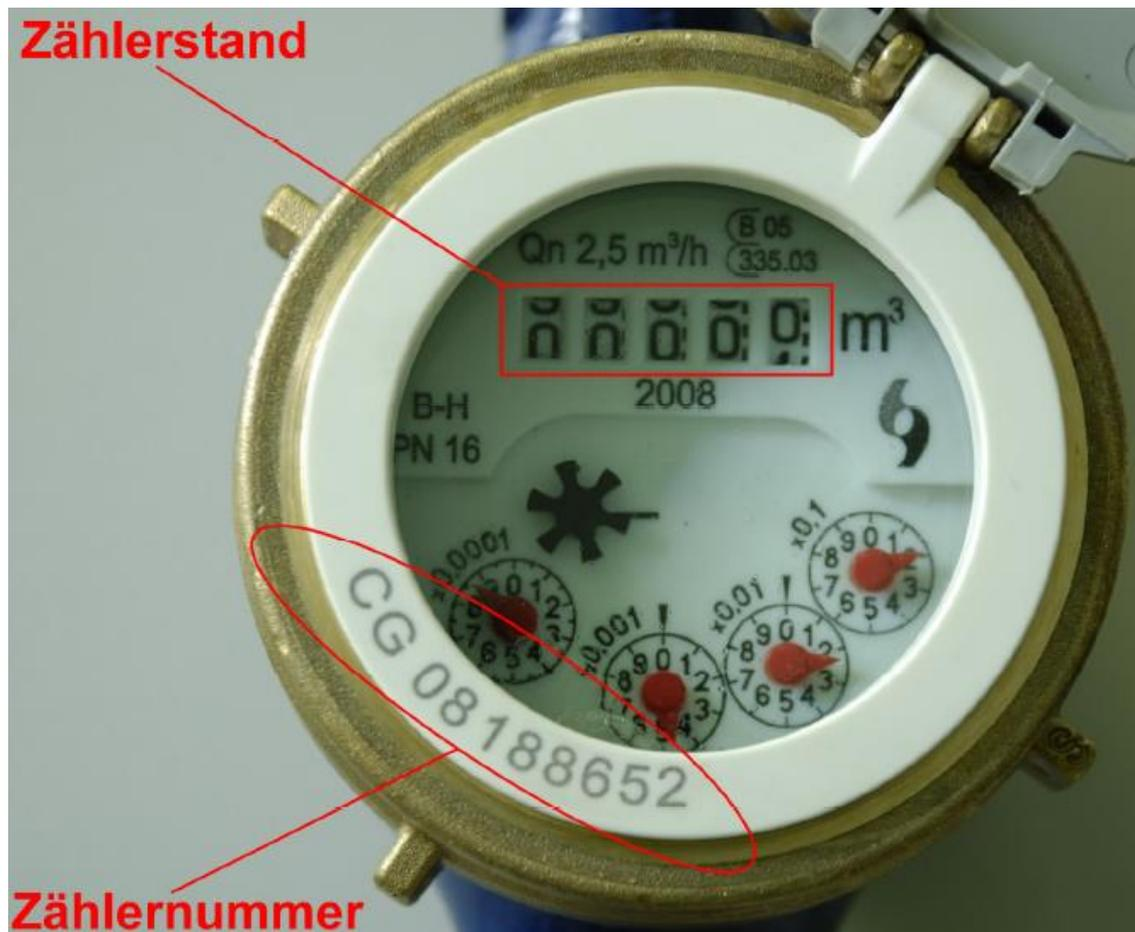
Die Zählernummer befindet sich in der Regel auf dem äußeren Rand des Zählers. Bei älteren Zählern kann sie sich auch unter dem Glas im Bereich der Anzeige des Zählerstands befinden.
